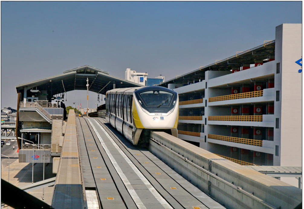
An der MRT Station Si Lam gelang Bernd Zöllner diese Aufnahme der „Yellow Line“-Einschienbahn. Diese Strecke ist durchgehend zweispurig und aufgeständert. Sie hat keine Verbindung zu einer anderen Einschien-Linie.
