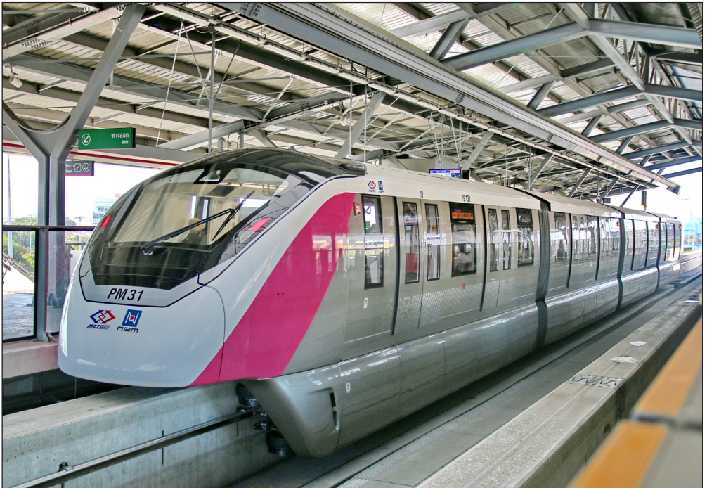
Im Vorstadtbezirk Min Buri startet bzw. endet die „Pink Line“. Das ist mit 34,5 km die längste Strecke. Eingesetzt werden 42 Züge vom Typ Alstom Innovia 300. Weitere 28 Züge davon fahren auf der „Yellow Line“. Foto: Bernd Zöllner
